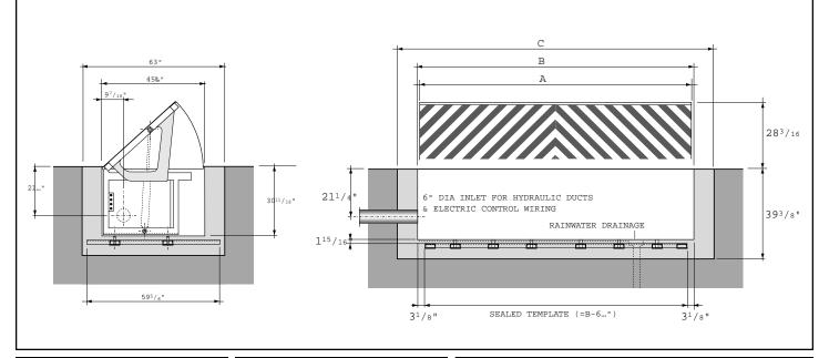
MODELRSB73 HIGH SECURITY ROAD BLOCKER BARRIER TECHNICAL DATA # ACS-1044-EN
